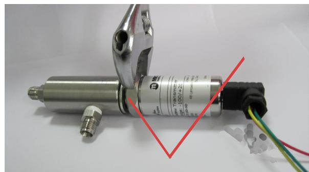
如用户要求，可提供一个一体式的不锈钢采样气室。当用于不锈钢管路系统的连接时，Easidew变送器和采样气室无须任何其它支撑。然而，如安装在聚四氟乙烯管道上时，采样气室有必要进行固定。建议在Easidew变送器装有采样气室时，气体流量为1~5NL/min。如采用直接安装方式的应用场合，气体流量可从静态到最高流速10米/秒。
